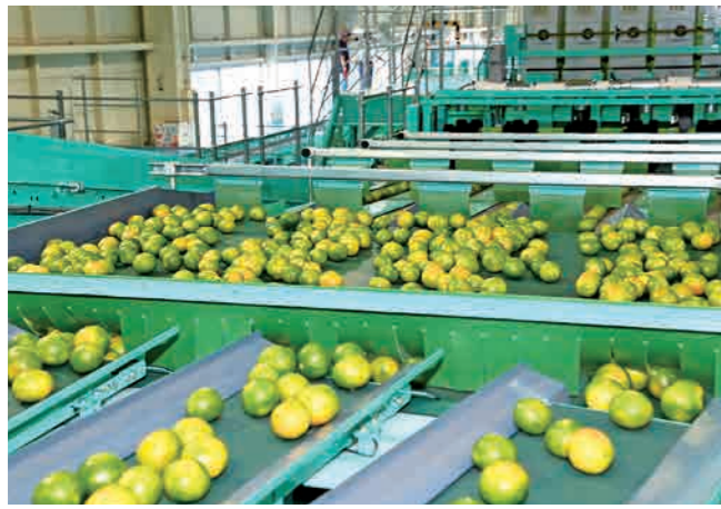
10月2日に初稼働したAI搭載の新選果機。湖北営農果樹センターで
